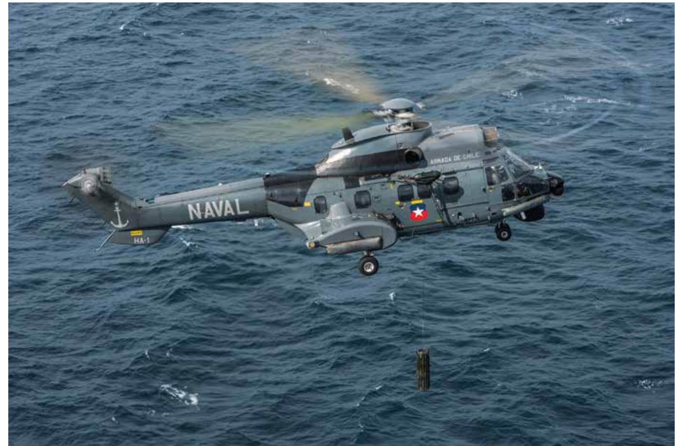
Os Cougar estão equipados com um sonar bastante sensível, capaz de detectar e classificar contatos submersos, o que é fundamental para proteger a frota chilena de ameaças submarinas.
